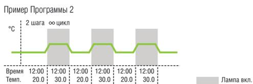
**Пример программы 2 • Режим таймера • 2 шага, цикл: Непрерывный повтор**
